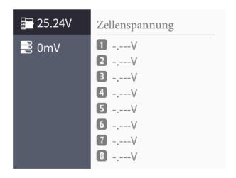
Wenn der XT60i an eine normale Batterie angeschlossen wird, zeigt der BG-8S nur die Gesamtspannung an. Ist der Balancer angeschlossen, kann die Spannung jeder einzelnen Zelle überprüft werden.
