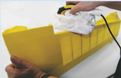
Abb. 12b Nach dem Einschneiden umschlagen und festbügeln.
