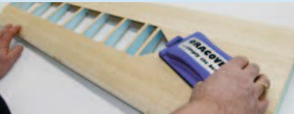
Abb. 2 Abschleifen der Oberfläche
